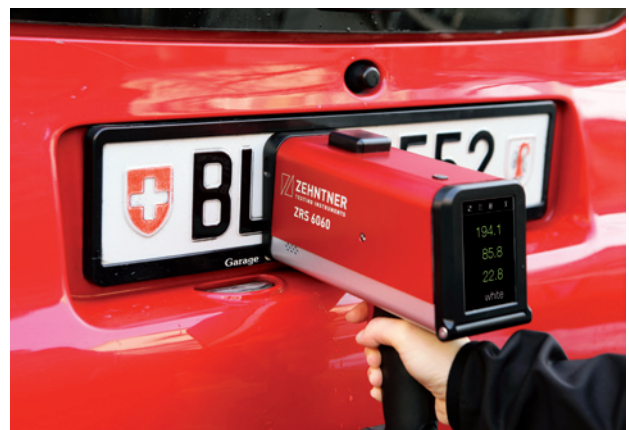
Measurement of retroreflective number plates / Messung von retroreflektierenden Autokennzeichen
